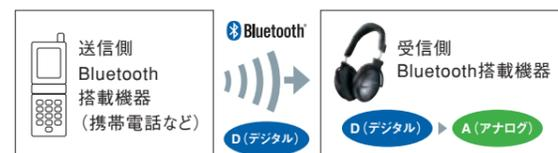
Bluetoothで送信される音楽データはデジタル信号で送られますが、ヘッドセットで音楽を再生し、人間が音楽を楽しむためには、デジタル信号をアナログ信号に変換する必要があります。この信号の変換が「D/A変換」です。
